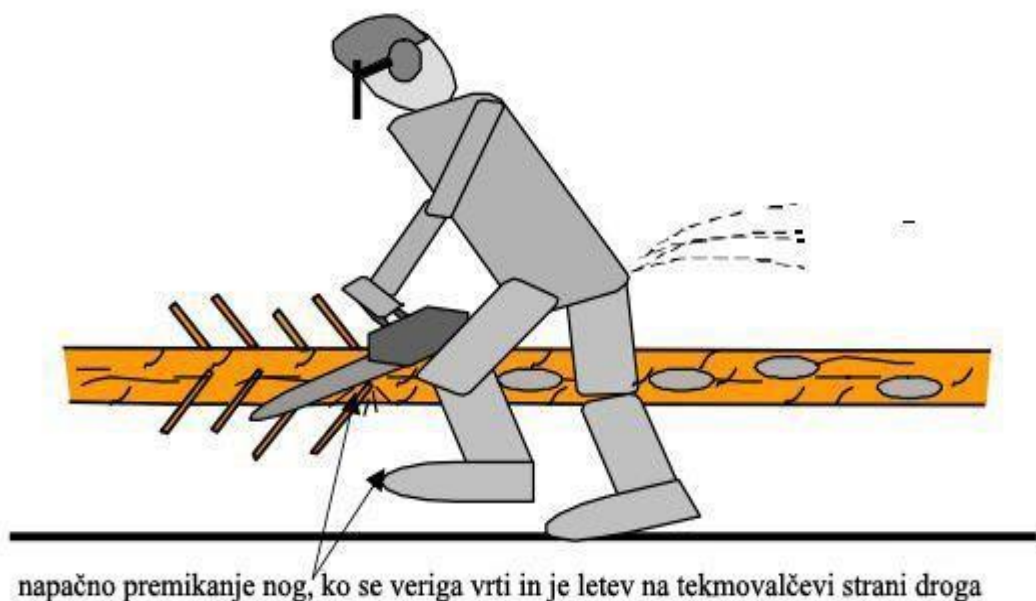
Slika 27: Napačno premikanje nog pri kleščenju
